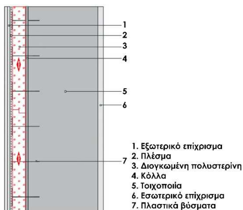
Σχήμα 13α: Διάταξη εξωτερικής θερμομόνωσης τοιχοποιίας.
